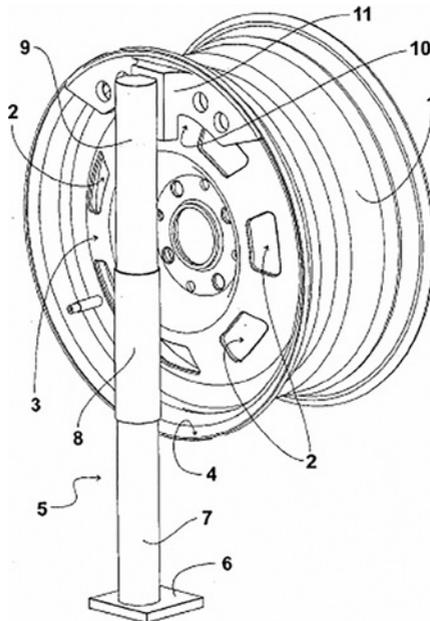
En el documento de patente N.º DE 10230179 se presenta un gato o “mecanismo para retirar neumáticos”. La invención consiste en un nuevo gato para levantar las ruedas montadas en los amortiguadores de un vehículo. Utiliza una estructura de apoyo (11) que encaja con el borde exterior (4) de las ruedas (1). El gato mueve directamente las ruedas y no el chasis del vehículo. Por tanto, se necesita una longitud menor de torno en el gato para levantar las ruedas del suelo.
